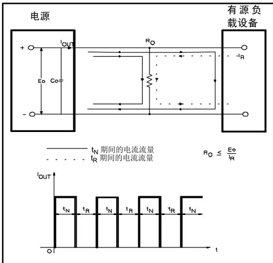
图 3 避免反向电流负载的方法
